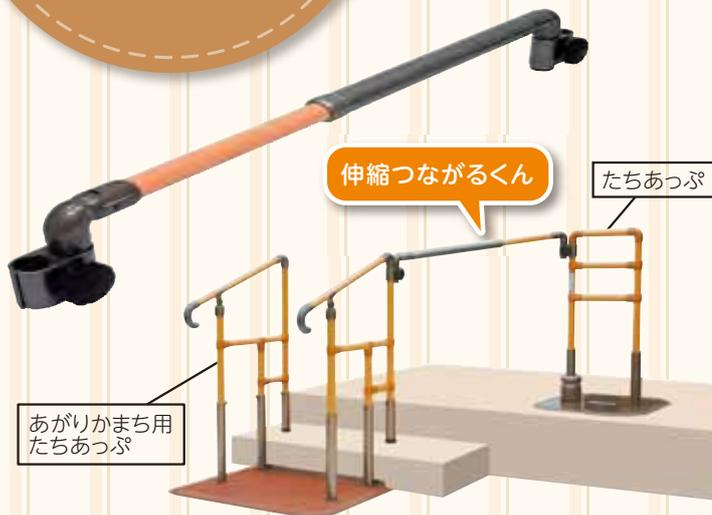
据置型手すり「たちあっぷ®」に取り付けることで、あがりかまち等の段差や居宅内の歩行動線を構築します。長さ64～95cmまで無段階で調整可能ですので、使用場所に最適な長さで取り付けることができます。上下45度まで、また左右も可動範囲内で調整ができるので、移動したい方向に手すりの設置が可能です。
